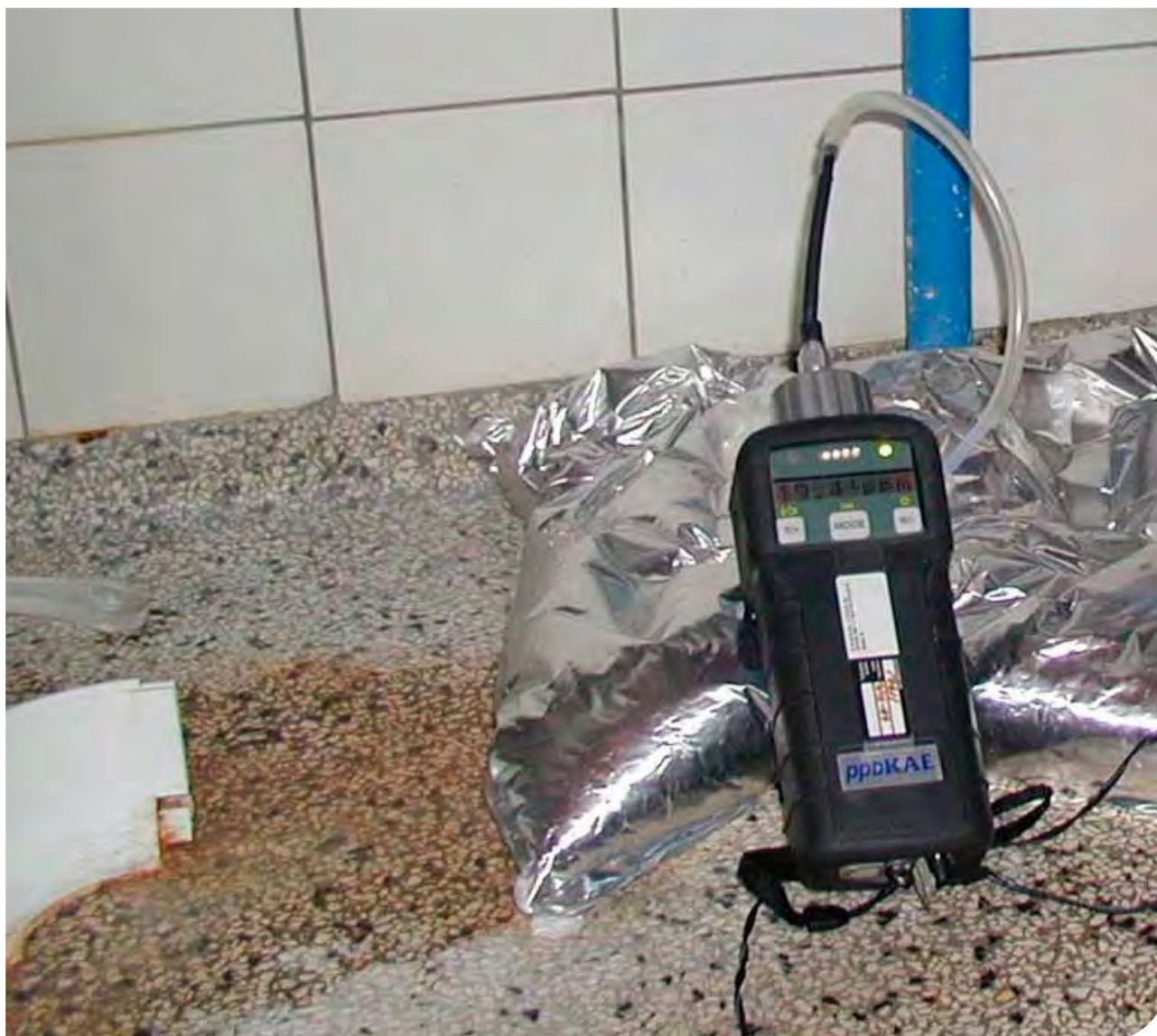
Foto: Sniffmätning i lägenheten ovanför ett tvätteri.
