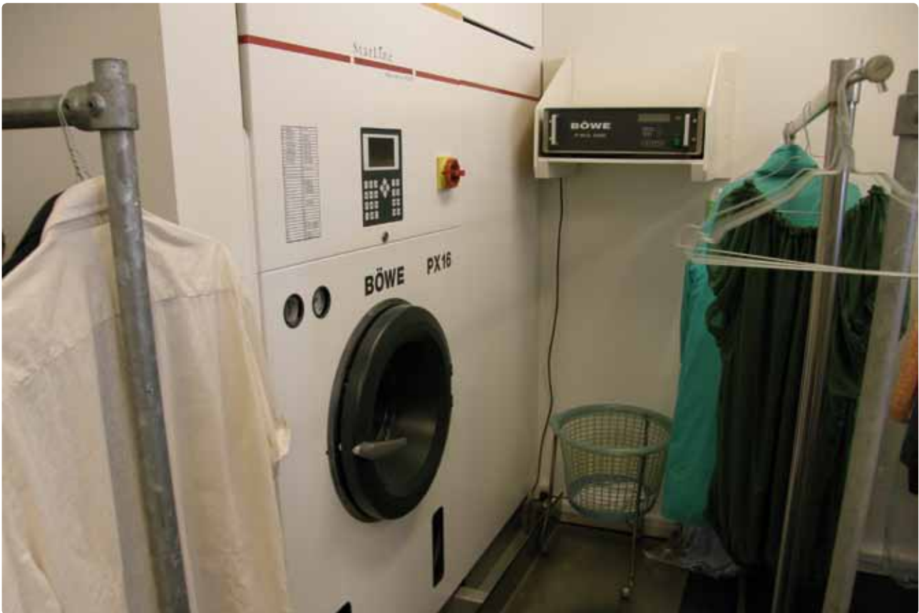
Foto: Kontrollmätning av tetrakloretylen i tvätteriet.
