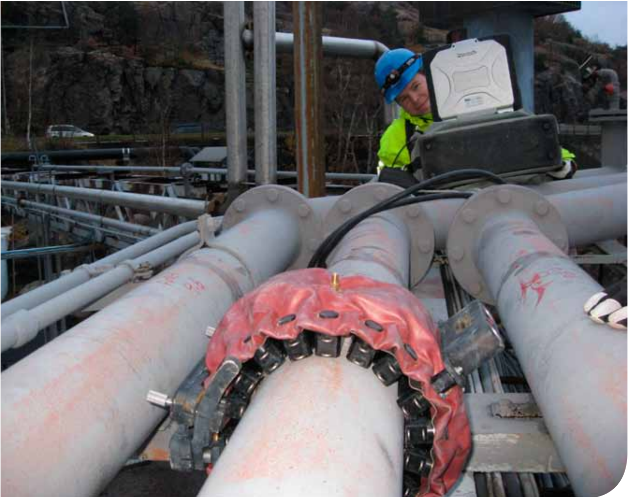
Long Range Guided Wave bälte med 24 st ultraljudssensorer
