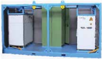
Transportabel fiber-laser til on-site svejsning, dimensioner: 4,6x2,0x2,15m (LxBxH). Foto: GSI SLV.
