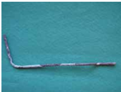
Eksempel på trådbinder af varmforzinket stål efter ca. 30 år. Meget dybe korrosionsangreb ved buk og på lige stykke
